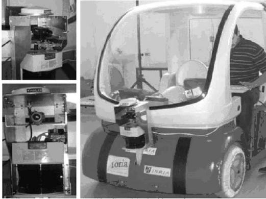
图 3 传感器的安装示意图
