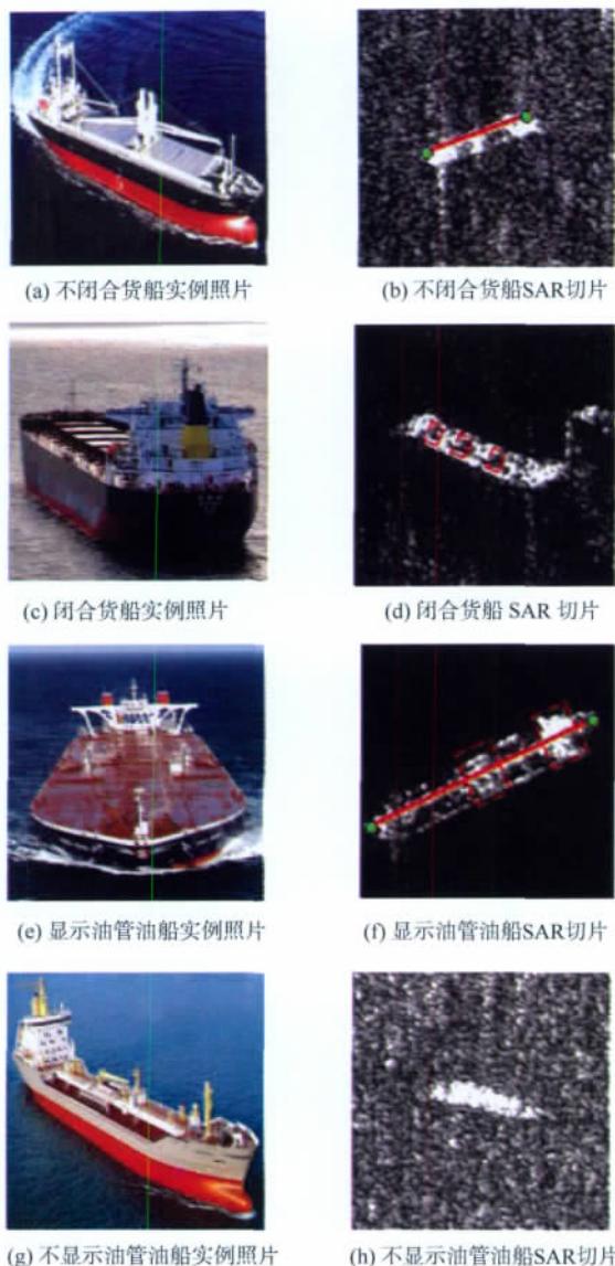
图 1 货船、油船实例照片和切片示意图
