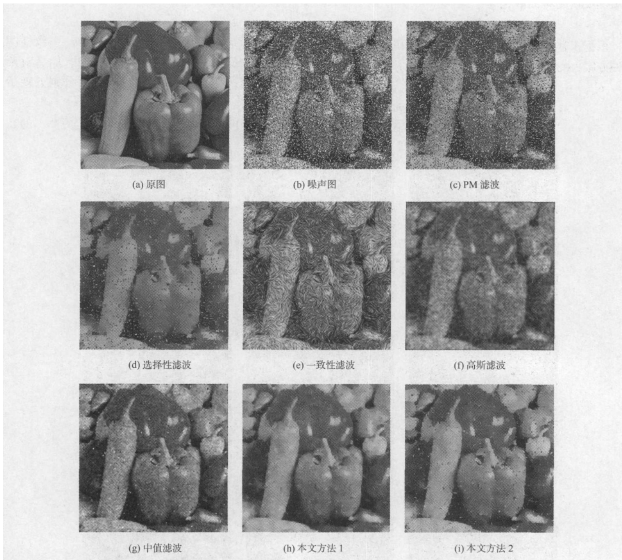
图 3 各种算法处理较多椒盐噪声的真实图像
