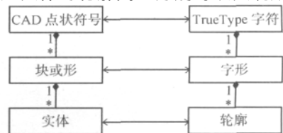
图 3 CAD 与 TrueType 符号模型映射
