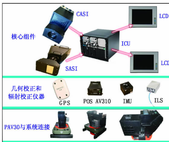
图 1 CASI/SASI 航空高光谱测量系统组成
