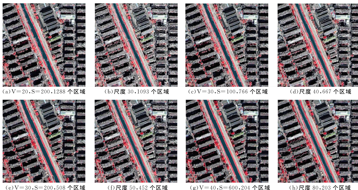
图6 实验图A多尺度分割结果,(a),(c),(e),(g)为本文方法分割结果,(b),(d),(f),(h)为eCognition分割结果
