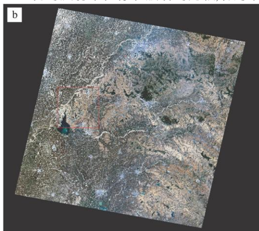
图 3 大气校正前 (a)、后 (b) Landsat ETM + 影像的真彩色合成图 (3 2 1 波段合成)
