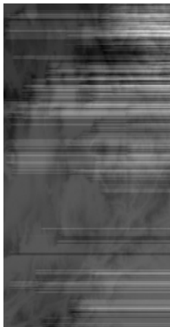
图 9 直接相位积分单波段解缠结果 Fig. 9 Phase unwrapping result of single band with direct integral
