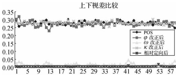
图3 各角元素补偿改正后求得的模型上下视差比较图
