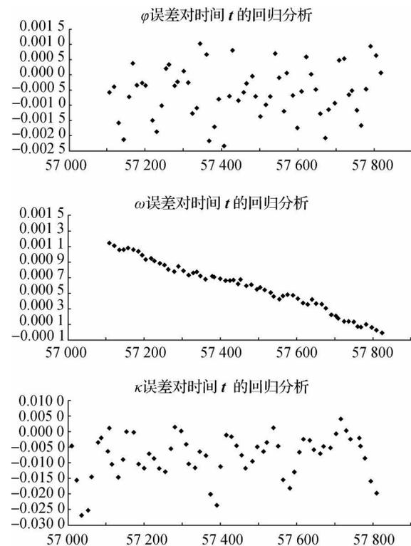
图 2 POS 角元素观测值误差对时间  $t$  的回归分析
