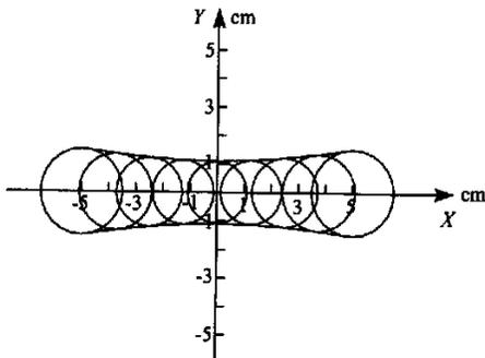
图 6 两端点同精度的误差带
