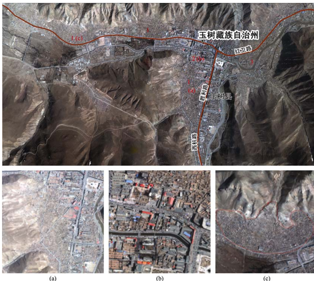
图 6 玉树结古镇房屋倒塌分布示意图
