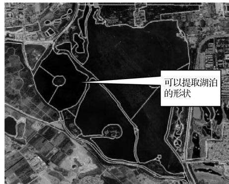
图 4 提取湖泊形状示例 Fig. 4 Extract lake shape information
