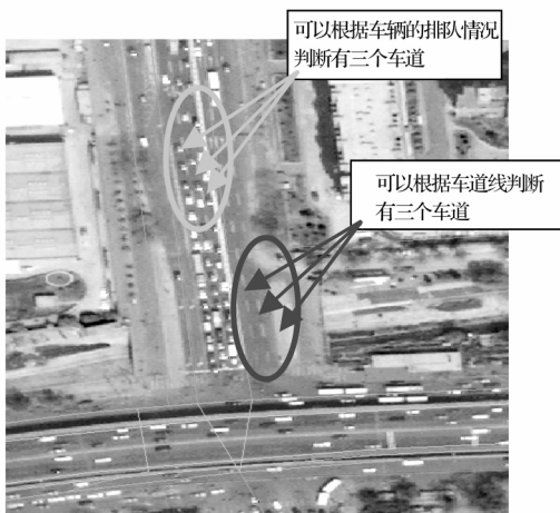
图 2 提取车道信息示例 Fig. 2 Extract lane information
