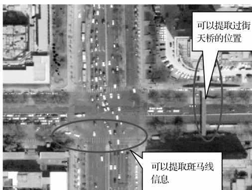
图 3 提取斑马线、过街天桥信息示例 Fig. 3 Extract pedestrian and overpass information
