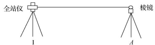
图3 棱镜误差检测示意图
