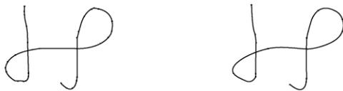
图6 拟合精度2(点), 节点数33 图7 拟合精度12(点), 节点数15
