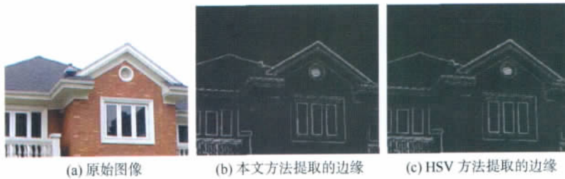
图 3 本文方法和 HSV 矢量排序法边界提取对比
