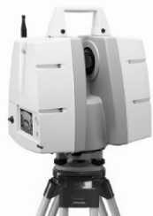
图1 Leica ScanStation C10 三维激光扫描仪
