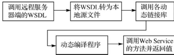
图3 Web Service 动态调用流程
