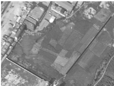
图3 控制点计算结果叠加在影像上的效果
