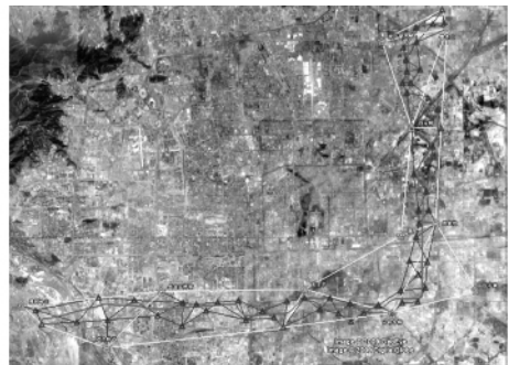
图 2 利用 Google Earth 布设的北京地铁 14 号线 GPS 控制网
