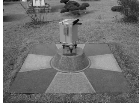
图 2 统合基准点的外形(架设仪器为 CG-5 相对重力仪)
