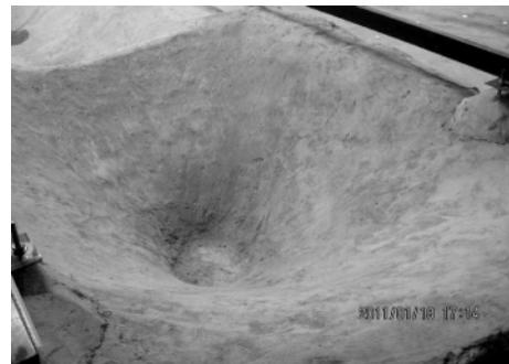
图2 冲刷坑地形模型
