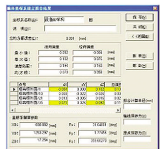
图 5 设备坐标系建立对话框 图 6 工件坐标系建立拟合结果图
