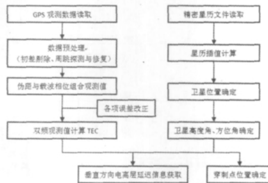
图 1 电离层延迟信息提取流程图
