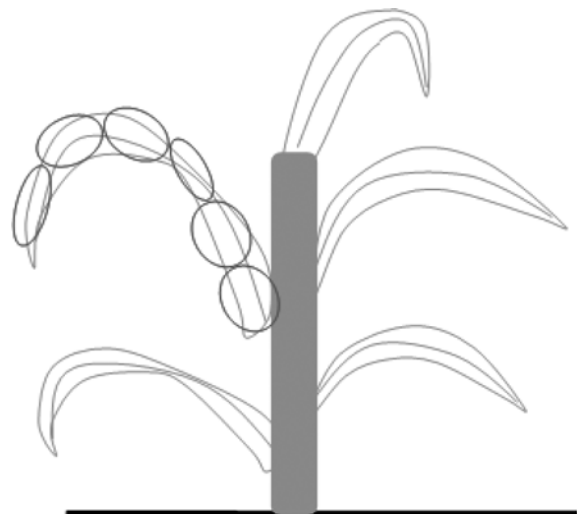
图 2 玉米叶看成随机朝向的圆盘集合
